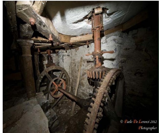
Mulino di Vigogna Particolare degli ingranaggi di azionamento delle macchine
